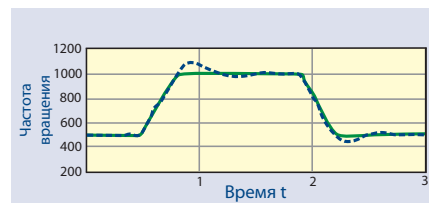
Без настройки (синяя линия) заданная частота вращения имеет явные отклонения. С настройкой (зеленая линия) перерегулирование сильно уменьшается.
